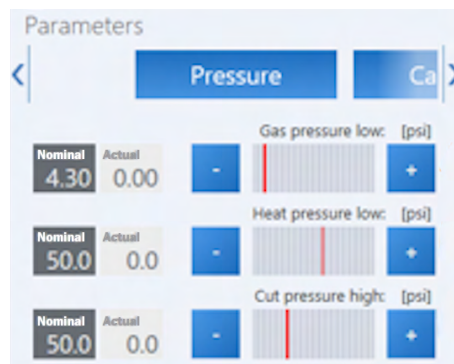
Koike Auto-Gas Interface on Katana CNC
